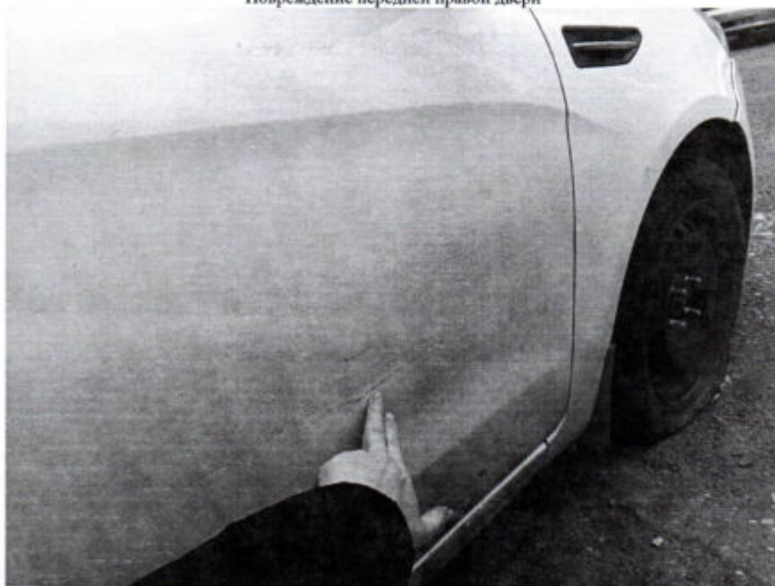
Повреждение передней правой двери
