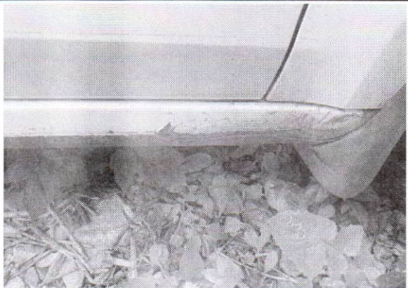
Порог правый - очаги коррозии
