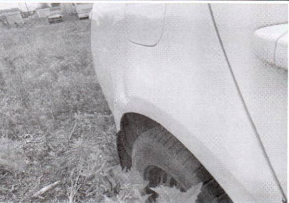
Крыло заднее, вмятина, следы ремонта
