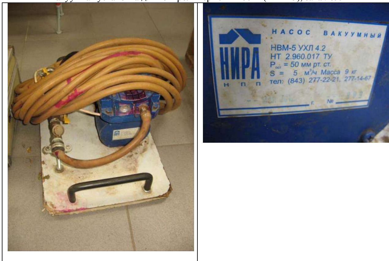
Вакуумная установка для контроля герметичности (НВМ-5), зав.№899
